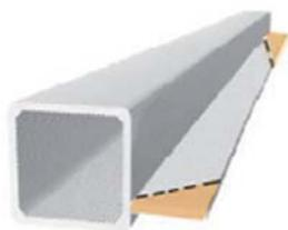
En el caso del corte a inglete, se realiza un corte de 90° en el cuadrado y un corte de 45° en el alma.
